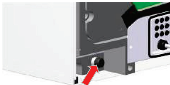
Fig. 7: Capac de evacuare a condensului (partea din spate)
