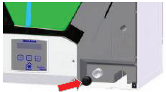
Fig. 11: Capac de închidere pentru orificiul de evacuare a condensului (partea frontală)
