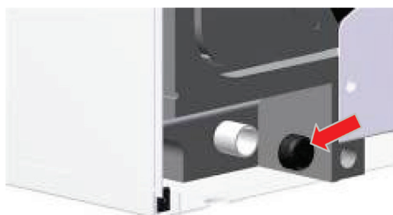
Fig. 8: Îndepărtarea dopului de la orificiul de evacuare a condensului (partea din spate)
