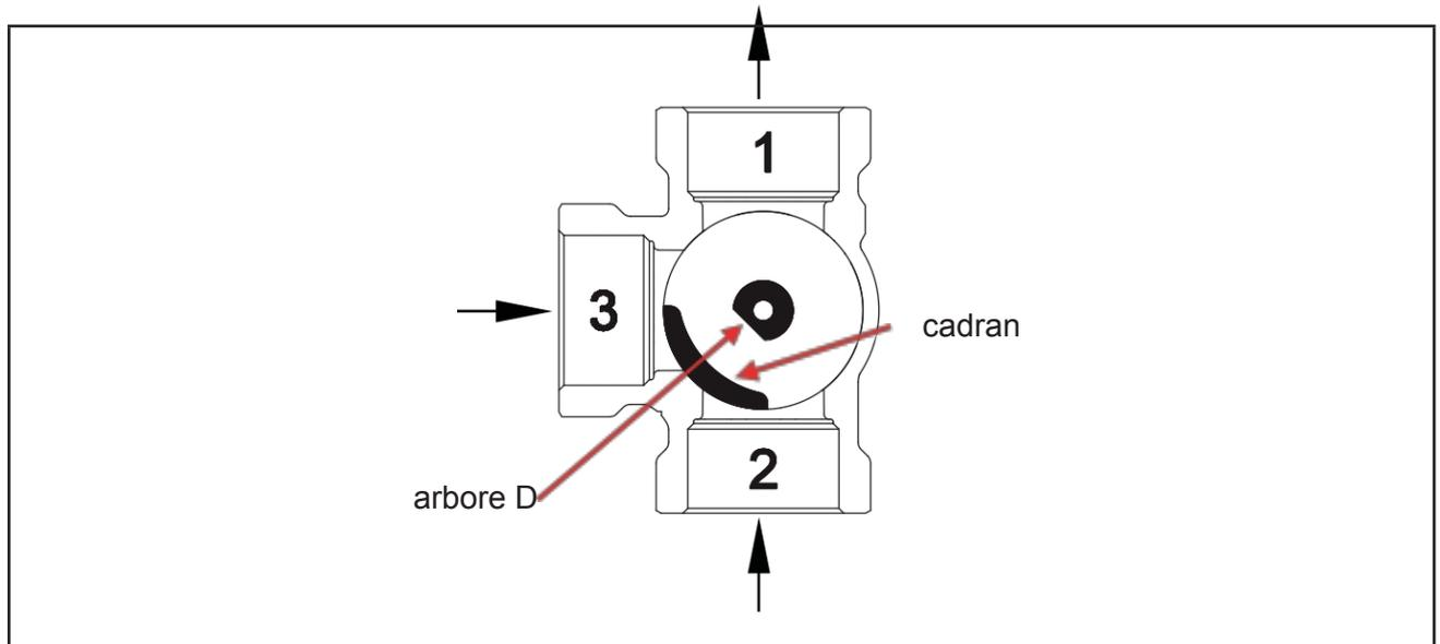
1. La montarea dispozitivului de acționare, rotiți arborele D în așa fel încât cadranul vanei să fie între intrările 2 și 3 la un unghi de 45°.
