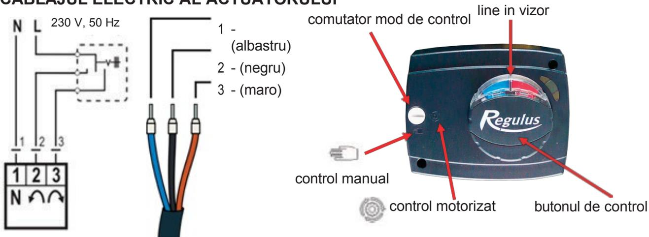
Actuatorul este setat din fabrică pentru control motorizat și este gata de funcționare. În cazul în care este inevitabilă îndepărtarea sau înlocuirea acestuia, vă rugăm să urmați instrucțiunile din anexă.
