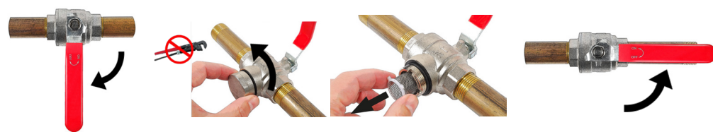
Obr. 6 - uzatvorenie ventilu Obr. 7 - vybratie filtračného sítky Obr. 8 - otvorenie ventilu
